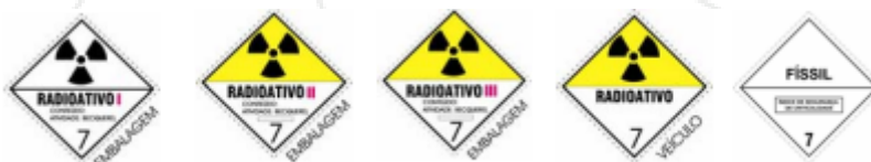
Figura 16- Rótulos de Risco da Classe 7 – Materiais Radioativos.
